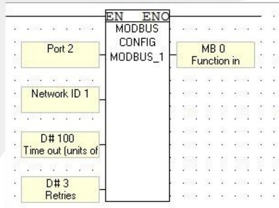
Bloco de configuração ModBus, conforme a tabela abaixo.
